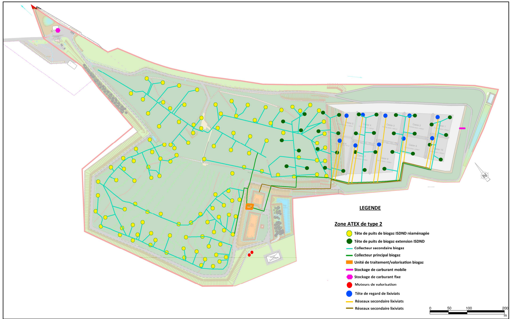
Figure 5 : Détermination du zonage ATEX
