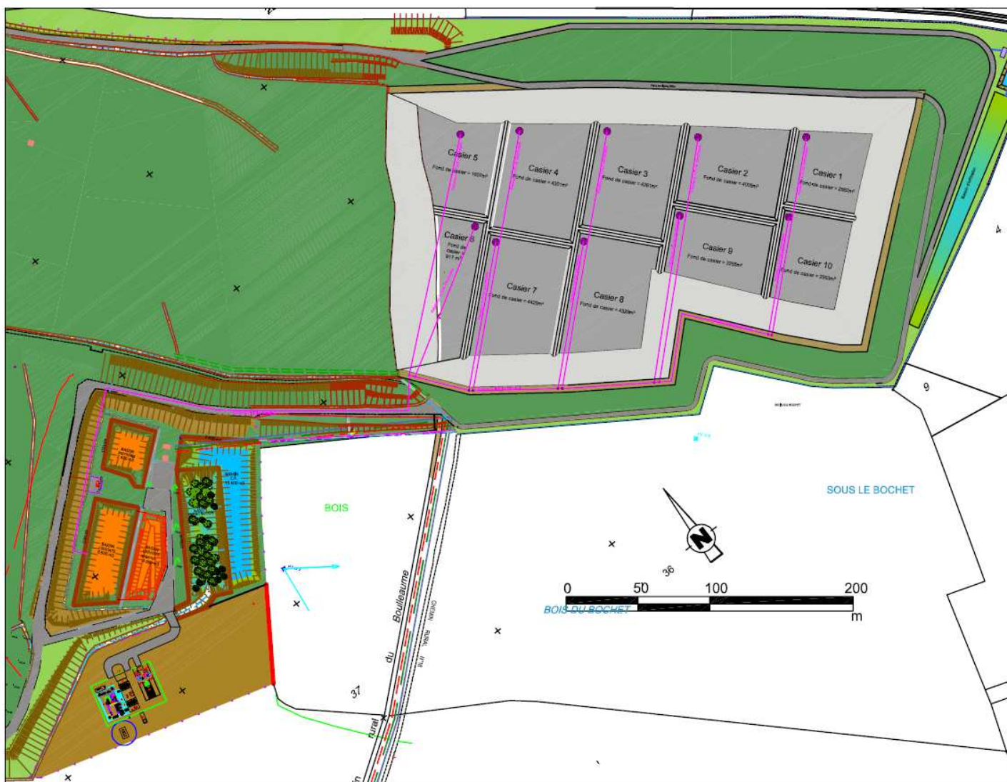
Figure 14 : Plan de principe du réseau de collecte des lixiviats
