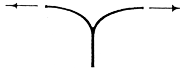
Figure 59 : Contrôle destructif en traction pelage
