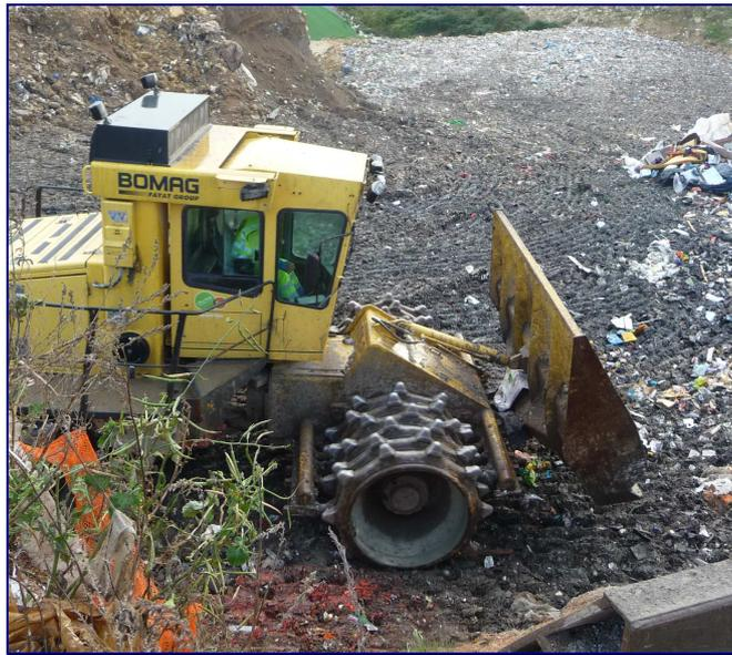
**Photo 1 : Compacteur de type BOMAG 772 RB 2**
